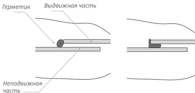
ного канала и шов, герметик не должен крошиться и трескаться. Подготовку поверхностей, нанесение, последующую очистку поверхностей осуществлять согласно инструкции по применению герметика. Порядок работ:
