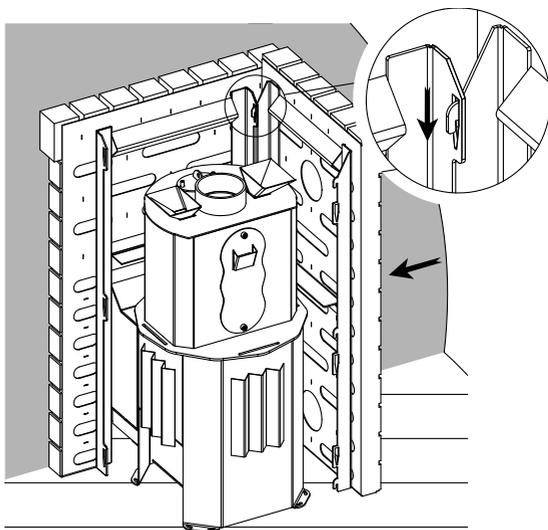
2) Установить печь на место постоянной эксплуатации. Последовательно собрать облицовку. Соединение панелей между собой происходит посредством крючков на одних и пазов на других панелях. Переднюю панель установить к стене, навесить на нее сначала одну, потом другую боковую панель, затем навесить заднюю.
