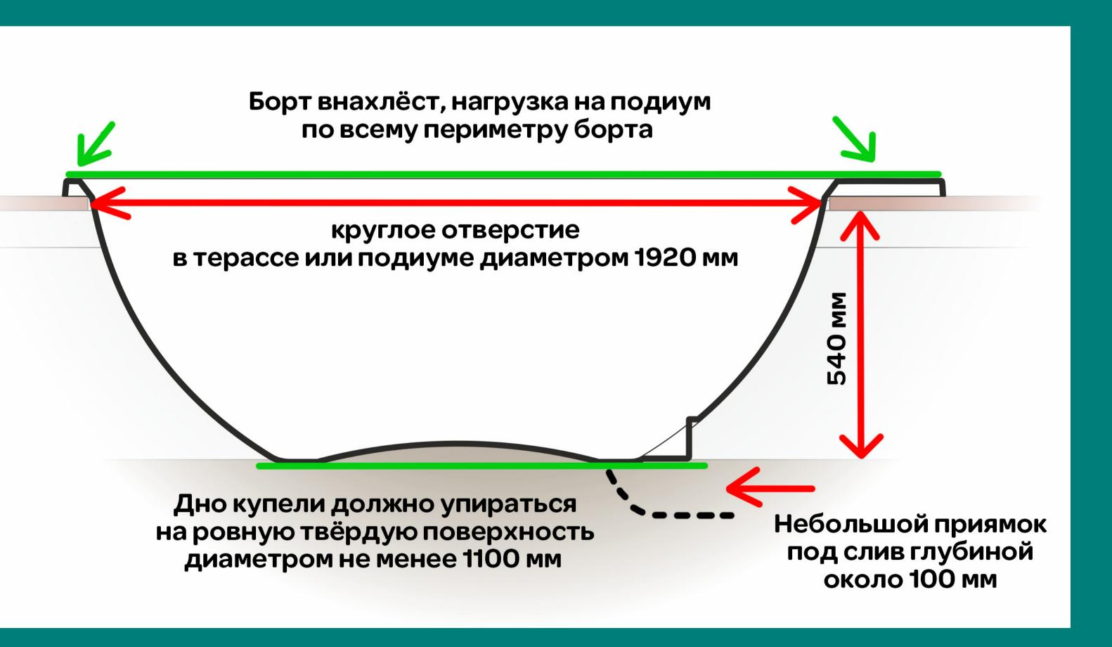
Встраиваемая купель должна быть установлена так, чтобы опора была по всему периметру борта и дна чаши. Недопустимо, чтобы чаша была подвешена на борт и не имела опоры снизу. Дно купели должно опираться на ровную твёрдую поверхность (бетон, деревянный настил) диаметром не менее 1100 мм.
